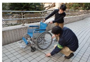
スロープの段差等の調査
